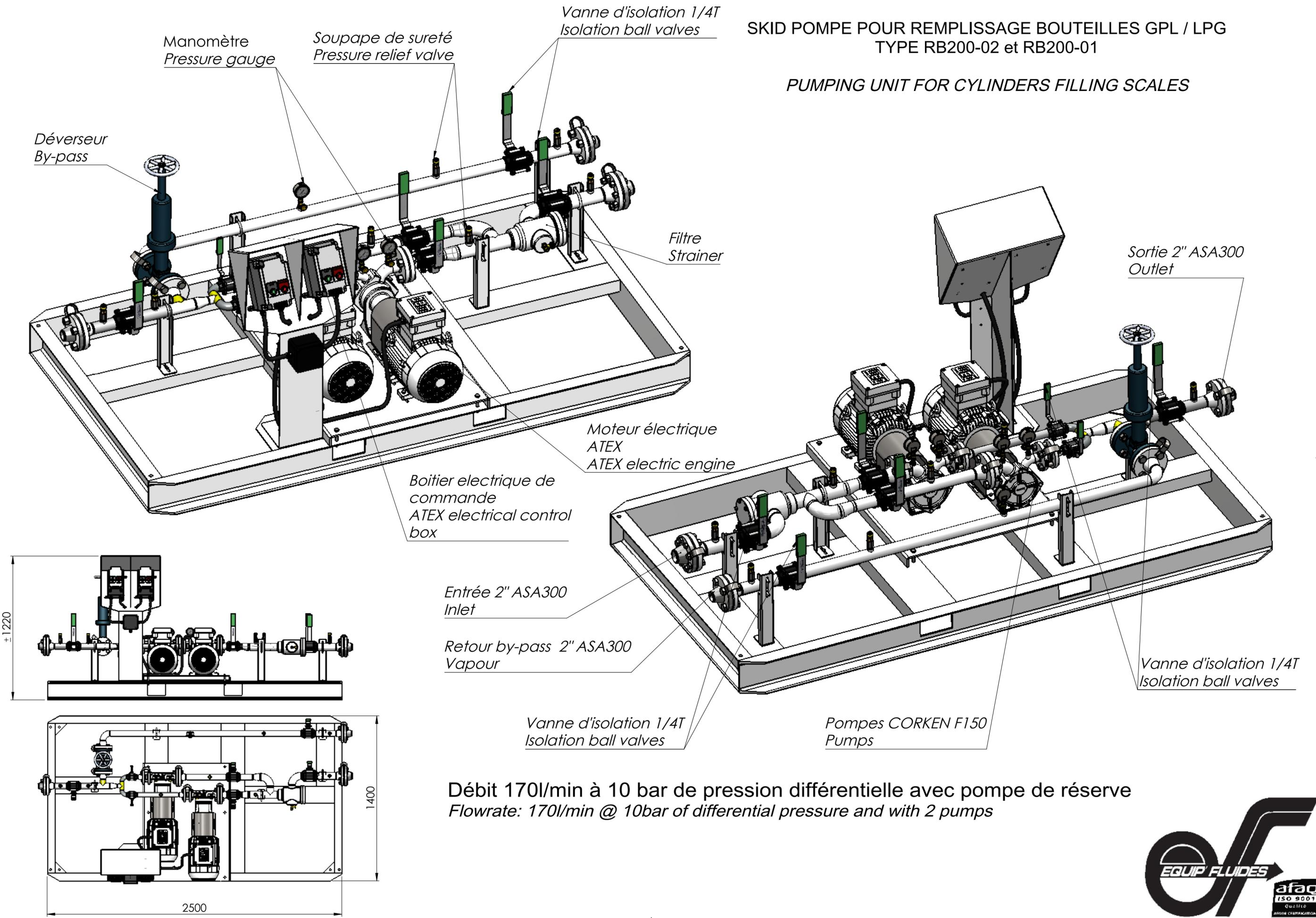
Débit 170l/min à 10 bar de pression différentielle avec pompe de réserve
