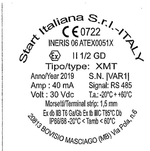
Exemple de marquage pour les indicateurs de niveau avec flotteur en NBR.
